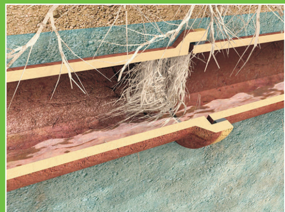
Wurzeleinwüchse können Kanäle und Abwasserleitungen undicht machen.
